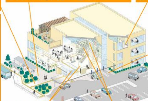
玄関や窓口業務事務室 の出入口の自動ドア化
