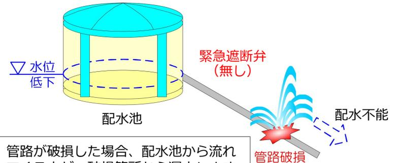
管路が破損した場合、配水池から流れてくる水が、破損箇所から漏水します。それに伴い、配水池の中の水も減少します。
