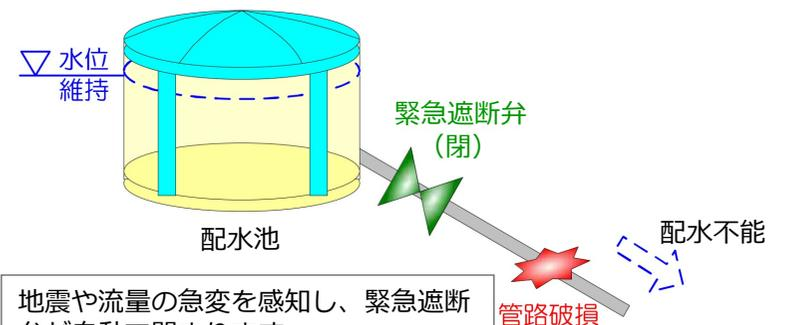
地震や流量の急変を感知し、緊急遮断弁が自動で閉まります。管路を通じた配水はできませんが、配水池の中に確保された水で、応急給水を行います。
