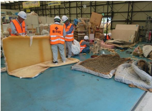
スプリング入りマットレスを布部分とスプリング（金属部分）に分ける様子
