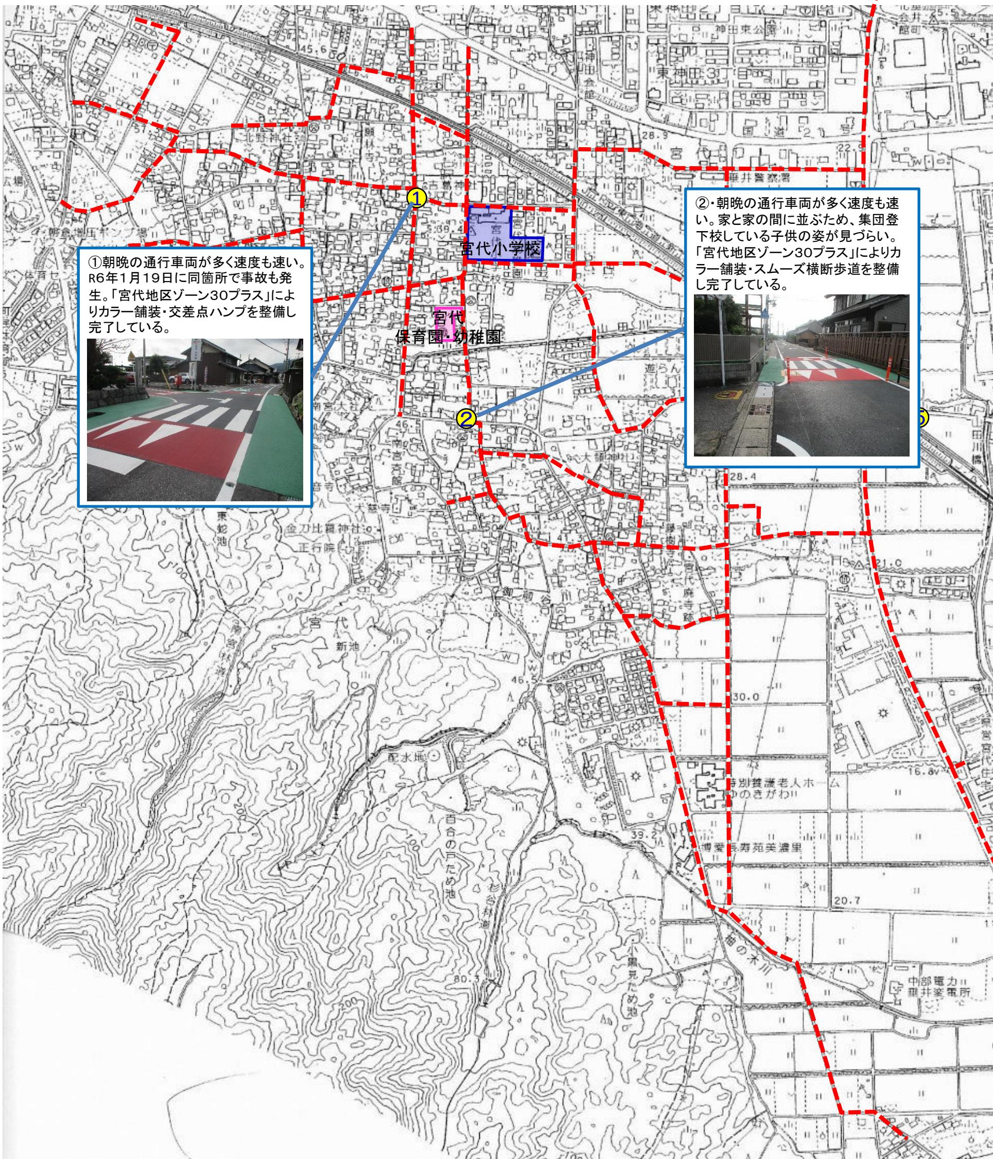
①朝晩の通行車両が多く速度も速い。R6年1月19日に同箇所でも事故も発生。「宮代地区ゾーン30プラス」によりカラー舗装・交差点ハンプを整備し完了している。
