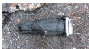
▲出火原因とみられる電気シェーバー
