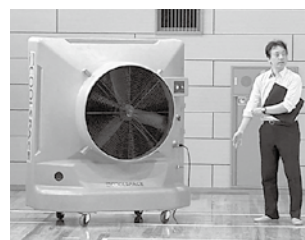
▲展示された気化熱冷風機
